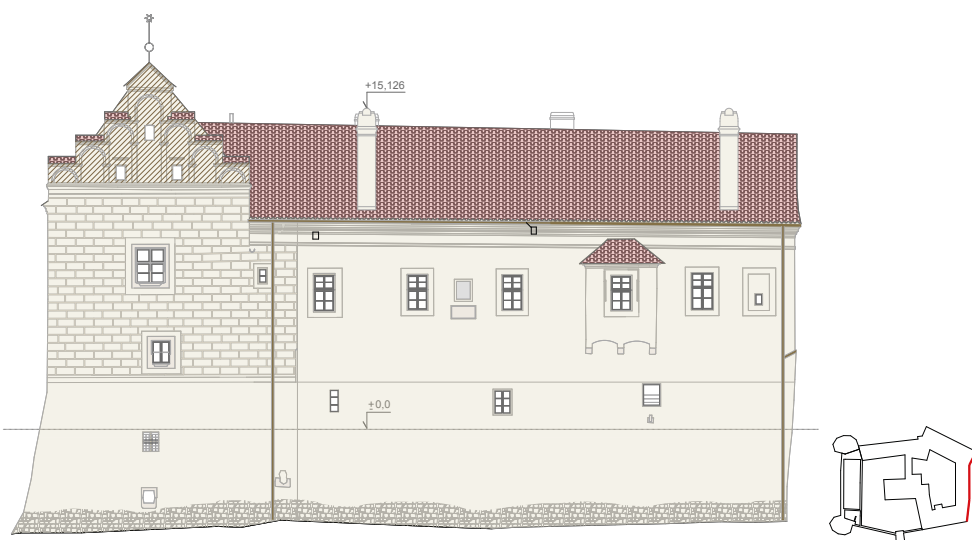
Obr. 5 Výkres vnější fasády areálu zámku Červená Řečice
