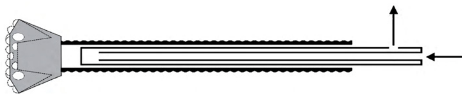
Obr. 3 Schéma energetické kotvy s uzavřenou koaxiální sondou. Šipky znázorňují směr proudění média.
