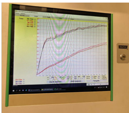
Obr. 1–3 Zkouška požárně ochranné účinnosti obkladu
