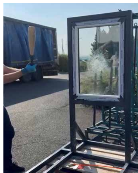
▲ Obr. 6 Test bezpečnostních skel IZOS Protect nejnižší třídy – sklo po úderu praskne, ale zůstane pohromadě
