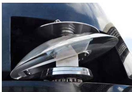
▲ Obr. 5 Skleněný disk minutovky v nejvyšším místě stroje mění s časem svou polohu (foto: Zbyněk Hrbata)
