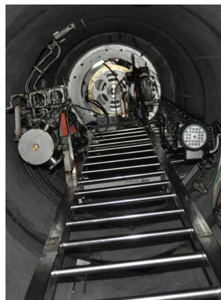
▲ Obr. 2 Vnitřní prostor hodinového stroje vytvořený vyřezáváním kamenných segmentů (foto: Josef Chybík)
