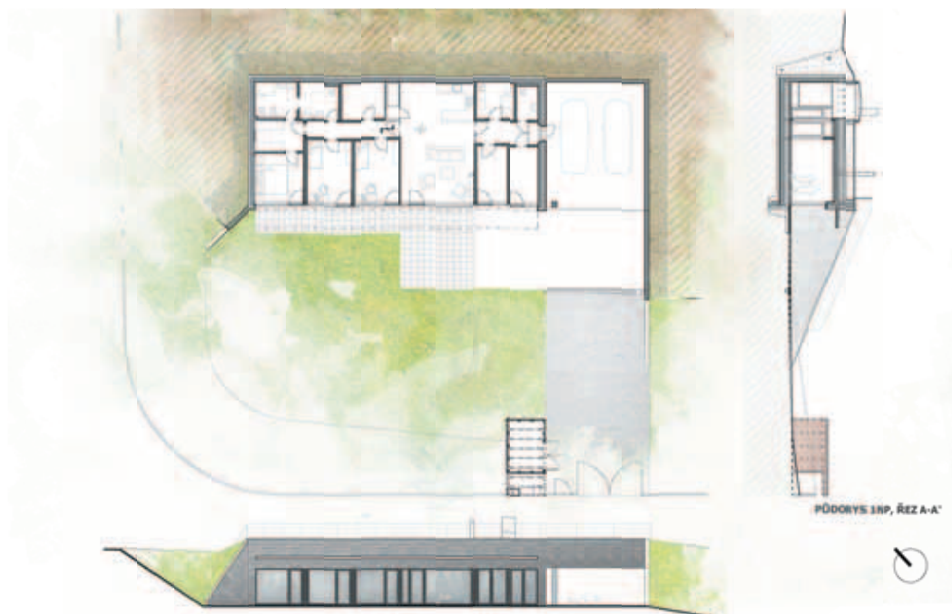
▲ Rodinný podzemní dům typu A, půdorys, řez a pohled
